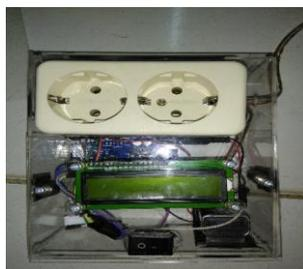
**Gambar 6.** purwarupa alat pengukur arus ac dan dc berbasis mikrokontroler arduino uno
