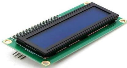
**Gambar 3.** Konfigurasi PIN Modul LCD & Ilustrasi Modul LCD Display
